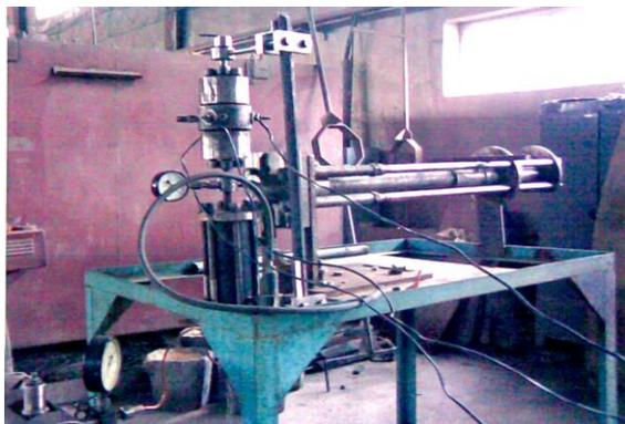
Рисунок 2 - Действующая модель гидроимпульсной пушки с мощностью выстрела до 20 кДж
