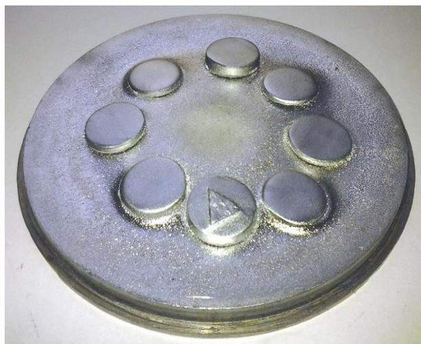
Рисунок 1 - Секционная мишень для осаждения твердых растворов NbMo
