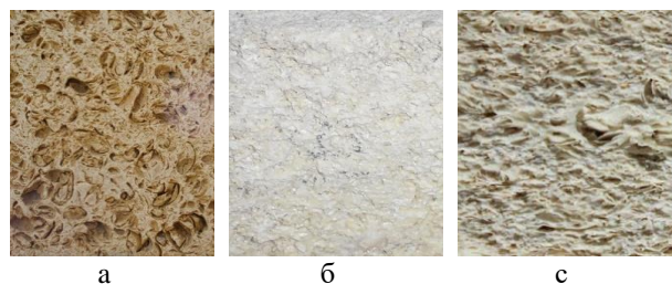
Сурет 1 - Әктас-ұлутас үлгілерінің құрылымы: а-Солтүстік-Шығыс кен орны; б-Бейнеу кен орны; с-Жетібай кен орны
