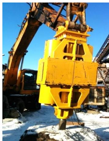
Рисунок 1 – Опытный образец электромагнитного молота, установленный на колесном экскаваторе марки HYUNDAI 210
