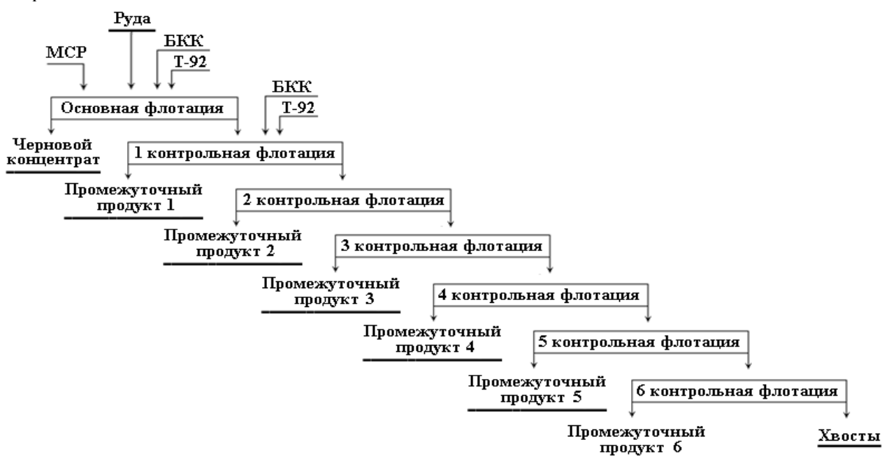
Рисунок 3 Технологическая схема по кинетике контрольной флотации
