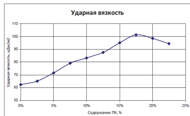
Рисунок 7. Зависимость ударной вязкости композиционного материала от концентрации ПК [15]
